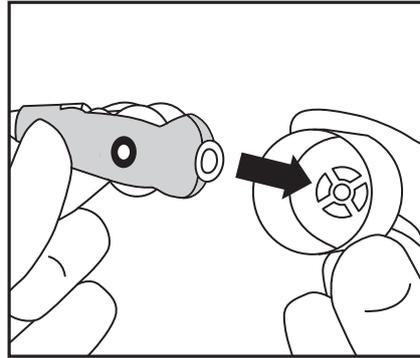
② 使い終わったテープを取り外し、新しいテープの固定紙を抜き、本体下の中央部分に取り付けます。
