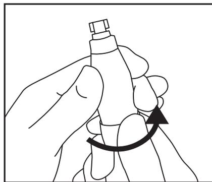
④ 本体下を「On」の方向へひねり交換完了です。
